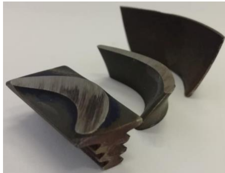
Obr. 3 Rezy lopatky plynovej turbíny motora iSTC-21v
